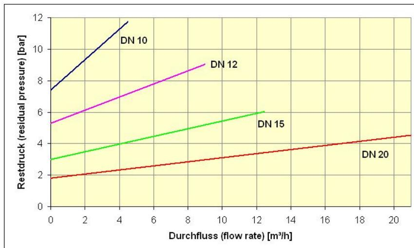
**Steuerdruck-Diagramme AG1 (control pressure diagrams)**
