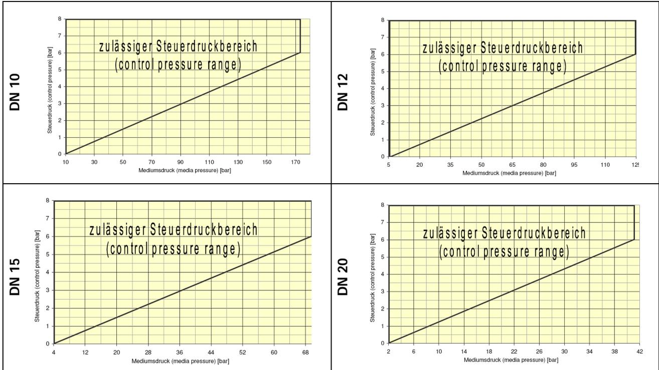
**Steuerdruck-Diagramme AG2 (control pressure diagrams)**
